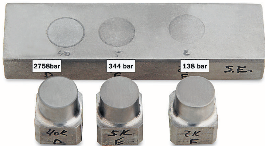
Rivnings-resultater på Expanite-hærdet 316-materiale viser ingen rivning på trods af højt tryk. Illustration: Expanite
