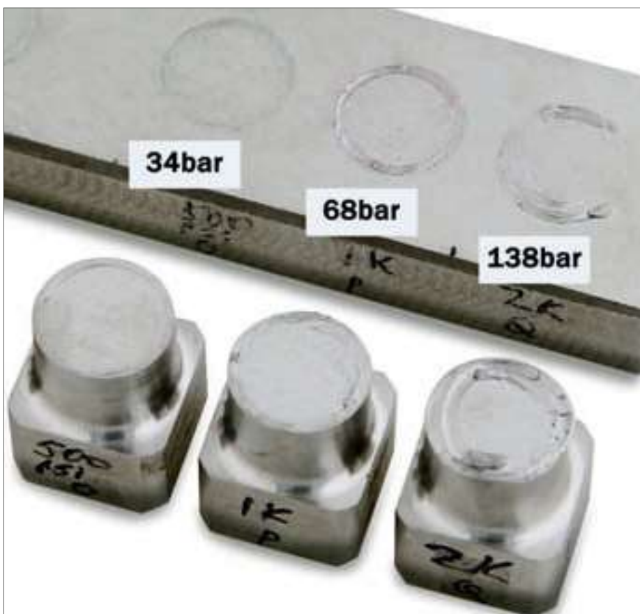
Billede 1. Rivningsresultater på ikke-hærdet 316-materiale viser tydelig rivning ved relativt lavt tryk.
