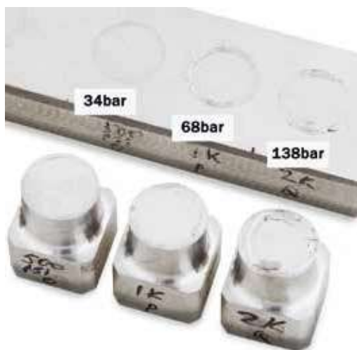
Billede 1. Rivningsresultater på ikke-hærdet 316-materiale viser tydelig rivning ved relativt lavt tryk.
