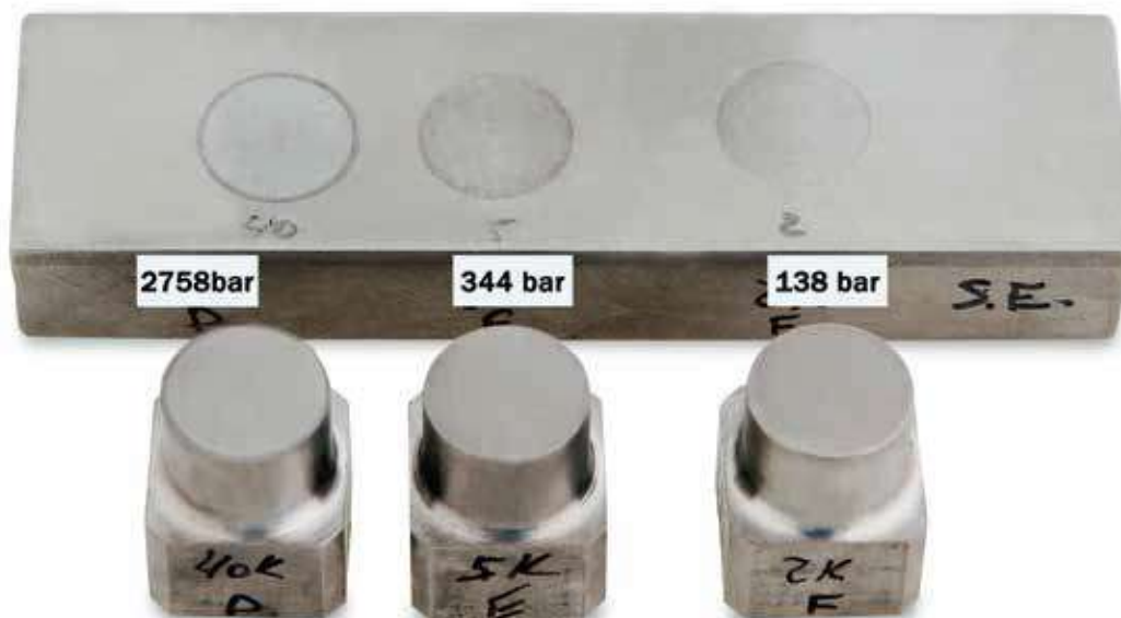
Figur nr. 2. Modstandsdygtighed over for rivning med Expanite-overfladebehandling.
