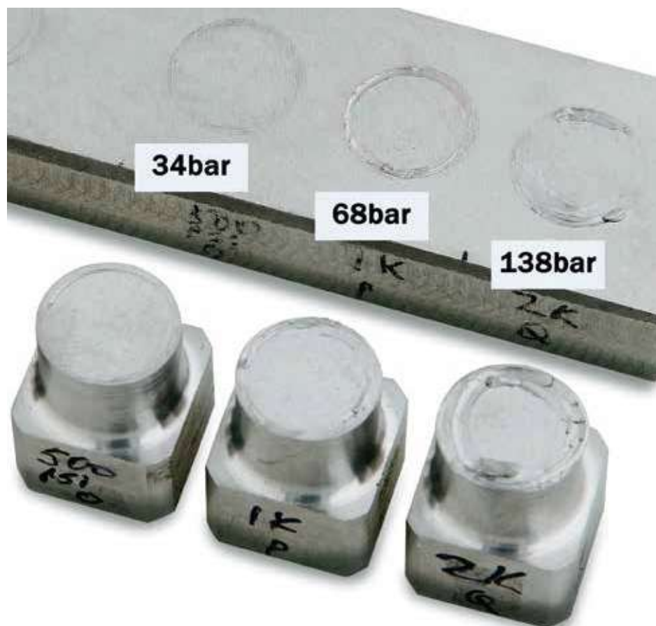
Figur nr. 1. Modstandsdygtighed over for rivning uden overfladebehandling.
