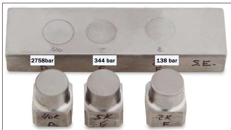
Figur 2. Modstandsdygtighed overfor rivning med Expanite overfladebehandling
