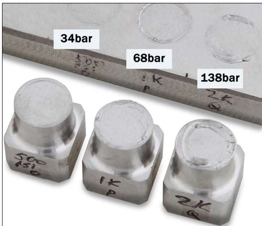
Figur 1. Modstandsdygtighed overfor rivning uden overfladebehandling
