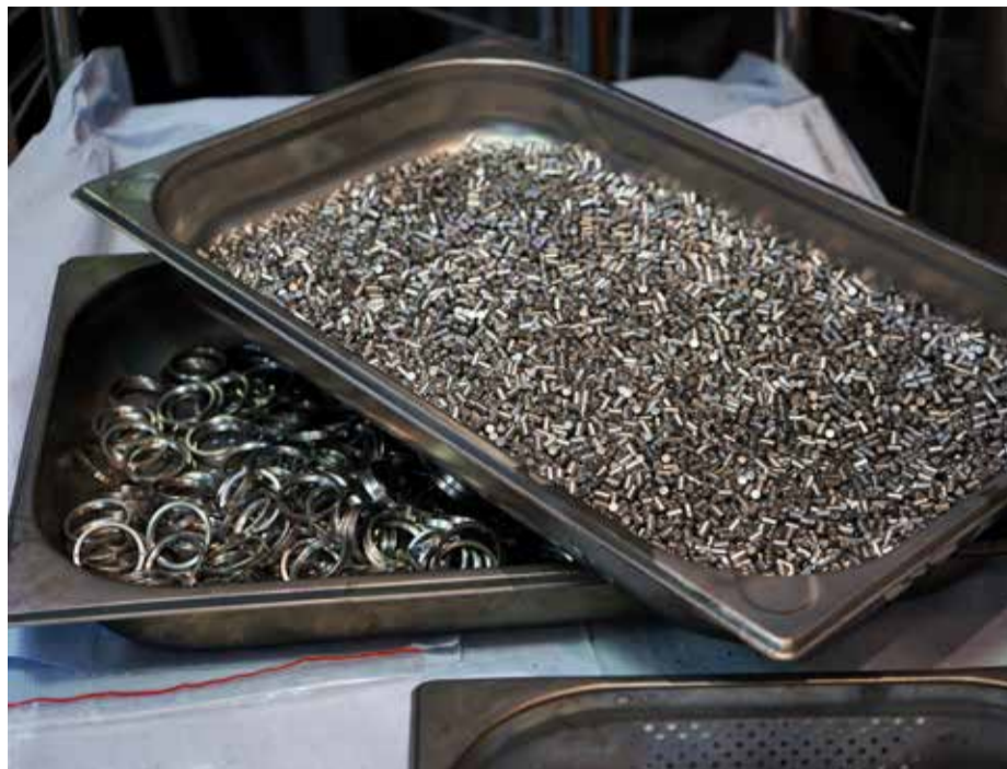
Fra spændskiver til pumpedele. I Expanites produktionshal ligger bakker med små og store komponenter, der har været en tur i ovnene og fået den særligt hårde overflade, der øger deres slidstyrke og korrosionsbestandighed mange gange. Virksomhedens kunder kommer bl.a. fra fødevarer-, automobil-, dental-, marine- og olie-gas-industrien.
