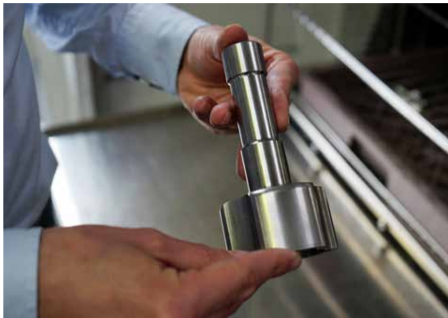
Fra spændskiver til pumpedele. I Expanites produktionshal ligger bakker med små og store komponenter, der har været en tur i ovnene og fået den særligt hårde overflade, der øger deres slidstyrke og korrosionsbestandighed mange gange. Virksomhedens kunder kommer bl.a. fra fødevarer-, automobil-, dental-, marine- og olie-gas-industrien.
