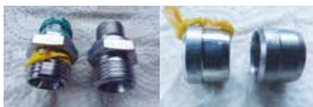
Billede 2/3. Venstre: Fittings i 316Ti (1.4571) uden og med Expanite-processen.
